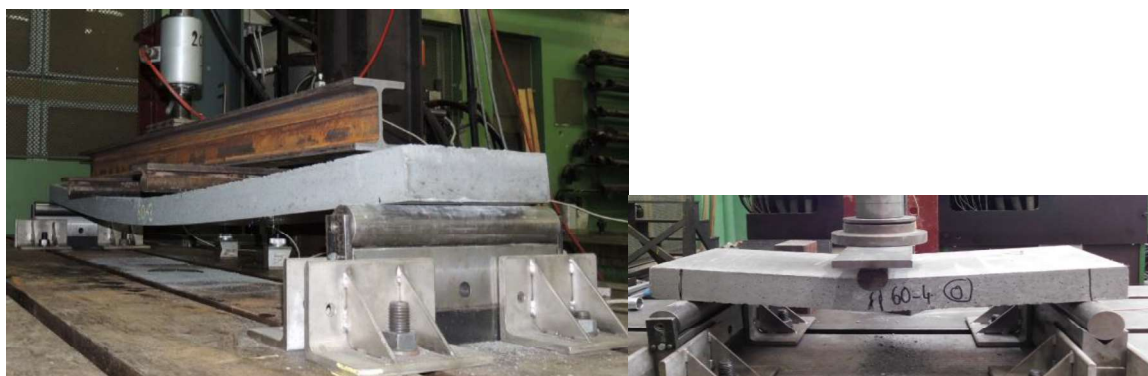
Obr. 3 Experimenty prováděné v Kloknerově ústavu - desková tělesa při zkoušce ve čtyřbodovém ohybu s rozpětím 1900 mm (vlevo) a ve třibodovém ohybu s rozpětím 600 mm (vpravo)
