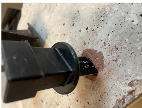
Zasazení senzoru do otvoru a zadusání cihlovým prachem
